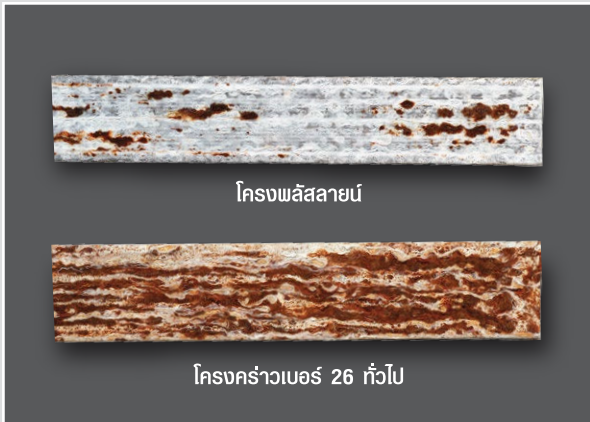
ภาพการทดสอบการป้องกันสนิมของโครงคร่าว โดยเป็นภาพก่อนและหลังการทดสอบการพุกร่อน (Salt Spray Test : ASTM B117-97, ASTM D1654) ที่ระยะเวลา 300 ชั่วโมง โดยเปรียบเทียบระหว่าง โครงคร่าวพลัสลายน์ กับโครงคร่าวเบอร์ 26 ทัวไป
